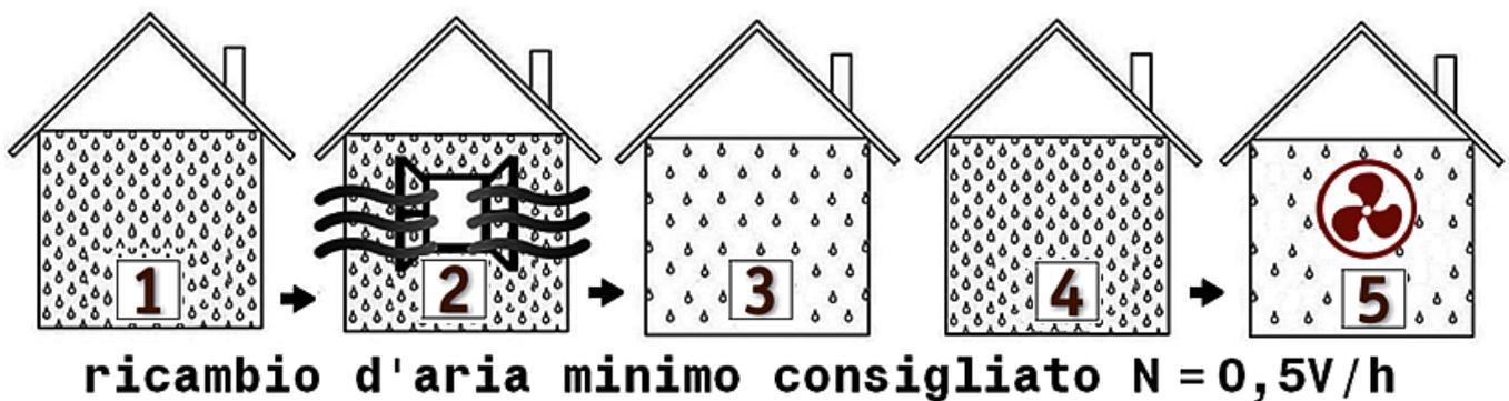
In linea di massima, nelle abitazioni, il ricambio d'aria necessario deve risultare prossimo ad almeno metà del volume d'aria, contenuta nell'ambiente, ogni ora:  $n = 0,5 V/h$ .
